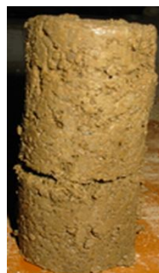
(a) 第 1 次干湿循环照片(素土样)
