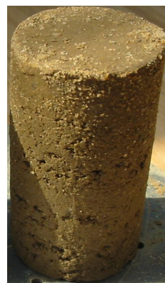
(b) 第 2 次干湿循环照片(CTMAB(石灰水)改良土试样)
