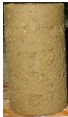
(c) 第 4 次干湿循环照片(CTMAB(石灰水)改良土试样)
